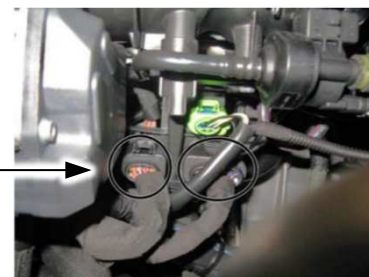
POSIZIONE DEL CONNETTORE AD 8 (O 10) PIN
